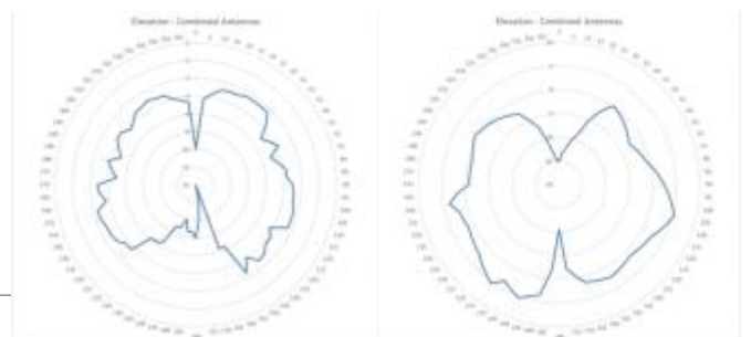
Patrones de antena de elevación RG-AP880-I de 2,4 GHz (izquierda) y 5 GHz (derecha)
